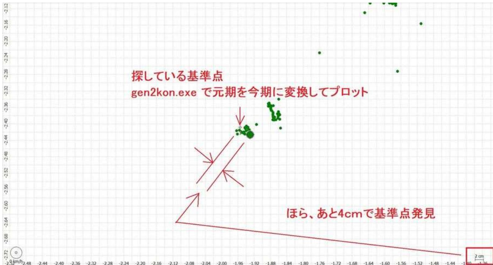
※既設基準点の探索には、RTKLIBの中の rtkplot を使用します
